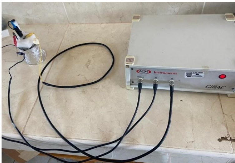
Figura 11. Prueba de voltamperometría cíclica en potenciostato a temperatura ambiente
