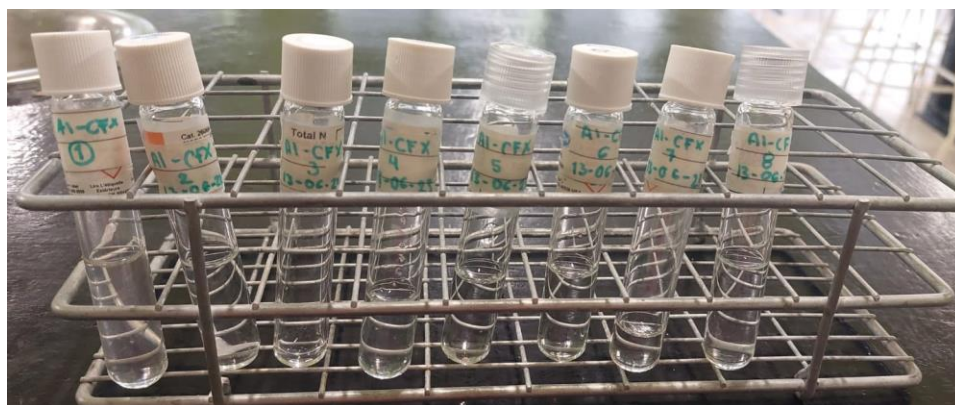
Figura 18.Recolección de muestras durante el monitoreo en diferentes tiempos del tratamiento de una prueba potenciostática a pH básico y potencial fijo de -310 mV por dos horas, con la tarjeta prototipo elaborada por los alumnos de Sistemas Computacionales del TESCO
