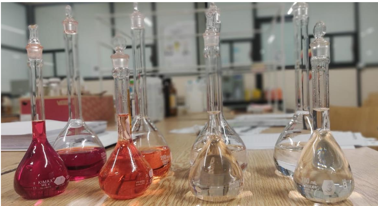
Imagen 5. Heredia S. (2023). De la preparación de solución de la solución madre, se sacaron alícuotas de diferentes concentraciones, en donde se prepararon en matraces volumétricos.
