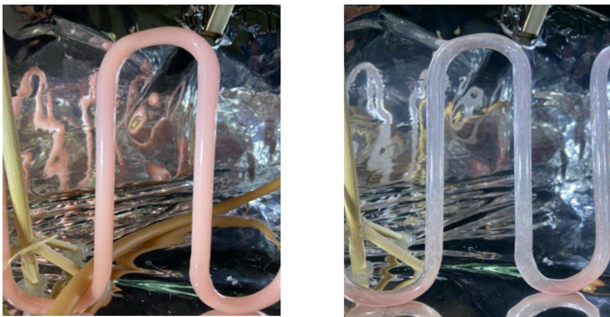
Imagen 7. Heredia S.(2023) Diferencia de degradación del colorante.
