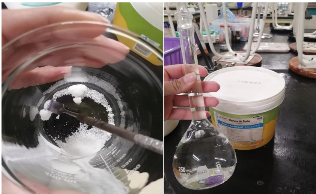
Figura 15. Preparación de la solución 0.5 M de NaCl para la obtención de la superficie porosa de aluminio.
