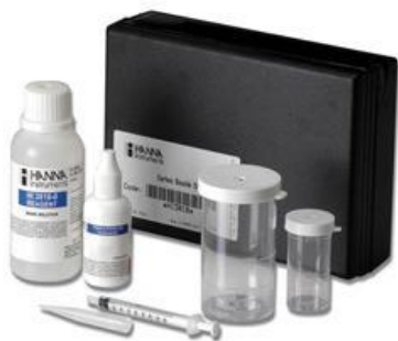
Figura 11 Kit químico marca Hanna Instruments HI3818
