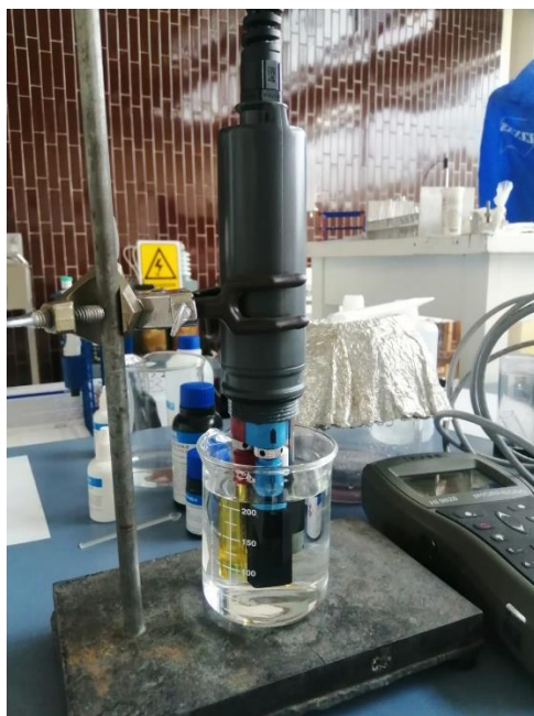
Figura 3. Sistema de caracterización de propiedades fisicoquímicas del agua activada por plasma.
