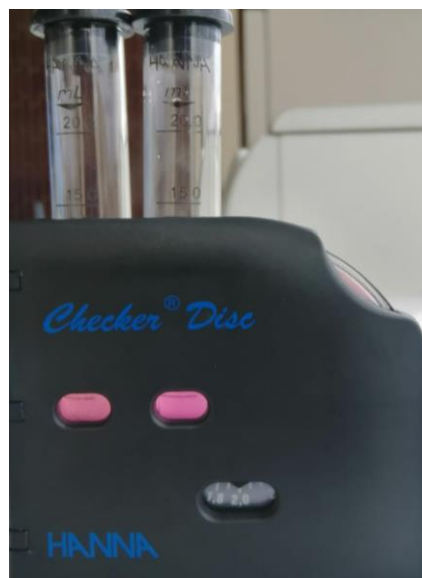
Figura 20. Prueba de ozono en una muestra de agua activada por plasma a cinco ciclos en T5.
