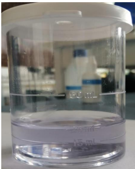
Figura 5. Muestra de agua activada por plasma con una concentración de 1.50 ppm de peróxido de hidrógeno.
