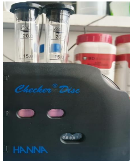
Figura 19. Prueba de ozono en una muestra de agua activada por plasma a cinco ciclos en T0.
