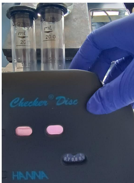
Figura 4. Realización del HI38054 Ozone Test Kit de HANNA® instruments.
