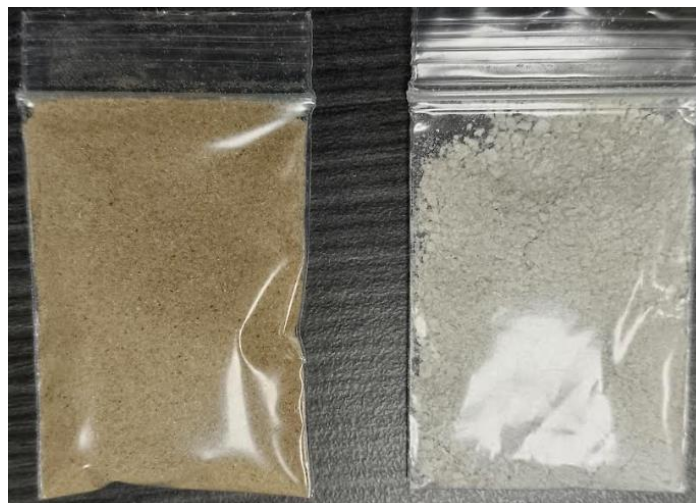
Figura 3. 13. RM utilizado para la extracción de azúcares y celulosa obtenida después del tratamiento químico
