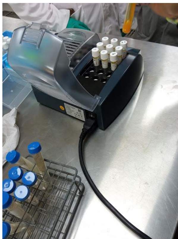
Figura 17 Proceso de digestión de los tubos de DQO
