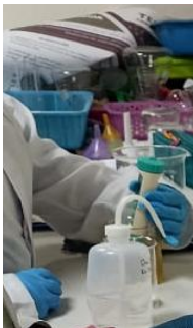
Figura 15 Medición de parámetros pH, conductividad eléctrica, temperatura, sólidos suspendidos
