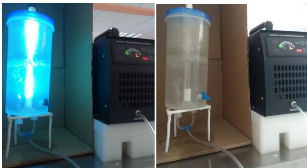
Fig. 11 Tratamiento UV/ \text{H}_2\text{O}_2/\text{O}_3 (izquierda), tratamiento \text{H}_2\text{O}_2/\text{O}_3 (derecha)
