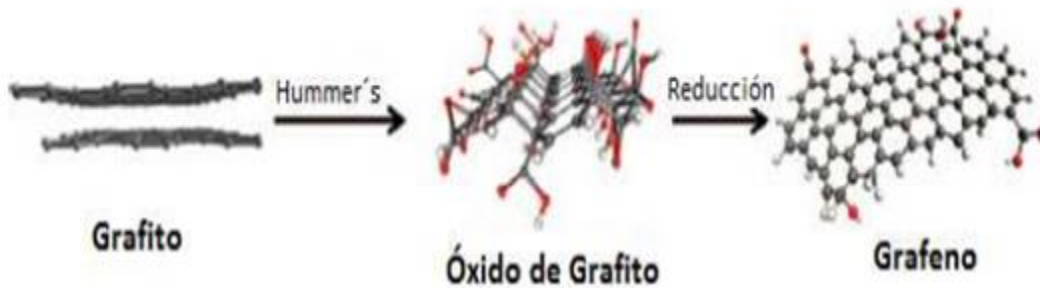
Figura 1.7. Proceso de conversión de grafito a grafeno en monocapa (I.Q. Barrera, 2016).
