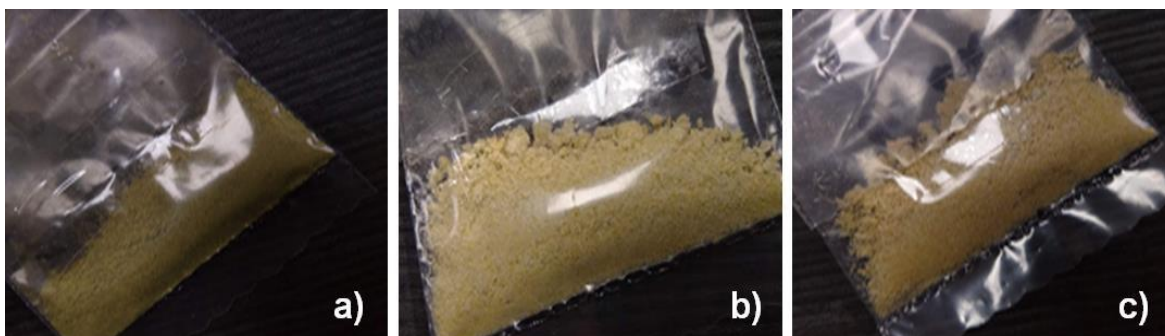
Figura 3.2. a) Penca de agave natural con corteza, b) Penca de agave con corteza-tratamiento 1 (hidrólisis alcalina) y c) Penca de agave con corteza- tratamiento 2 (hidrólisis ácida)
