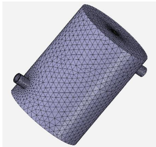
Figura 14. Discretización del CAD. Realizado en ANSYS AIM.
