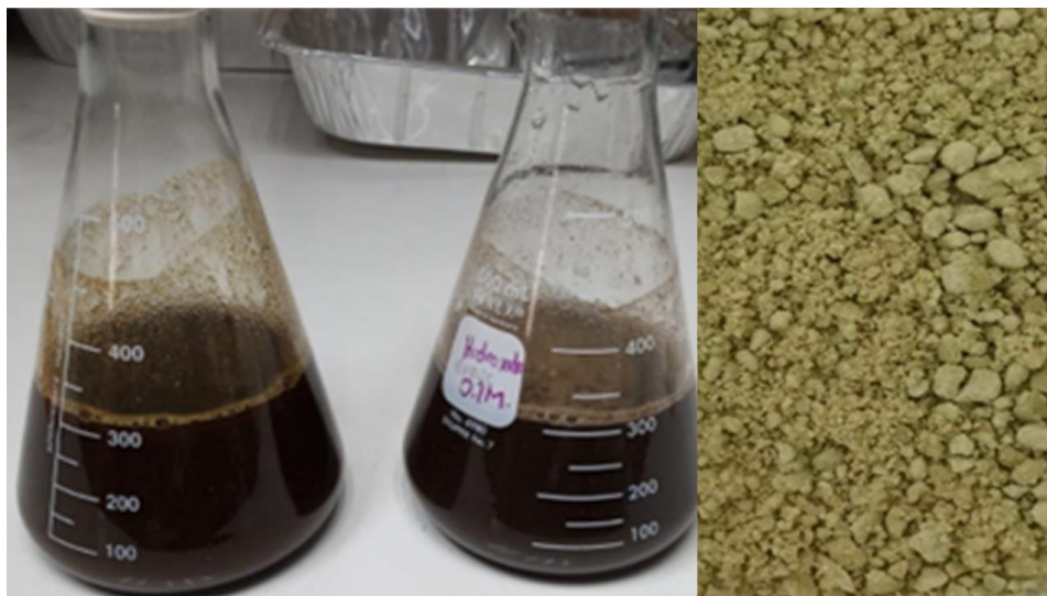
Figura 3.6. Material MCC3 obtenido de la primera hidrólisis de los tallos de rosa
