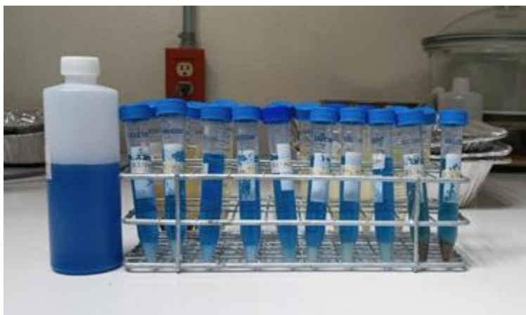
Figura 3.1. Cambio de coloración de las soluciones acuosas con índigo carmín, después del proceso de sorción.
