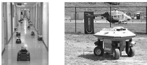
Figura 2-1. robots de interior (amigobot) y exterior (seekur) de activemedia.
