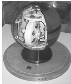
Figura 2-31. Girocompás desarrollado por herman anschütz-kaempfe en 1903
