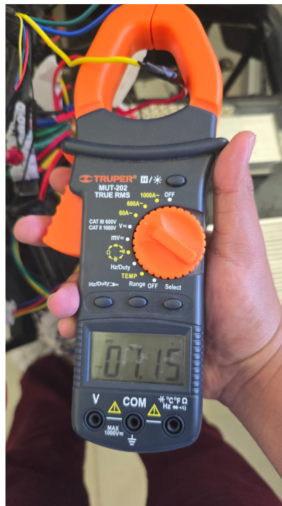
Figura 33: Medición al 100 % de aceleración de la corriente de la fase amarilla (Y)
