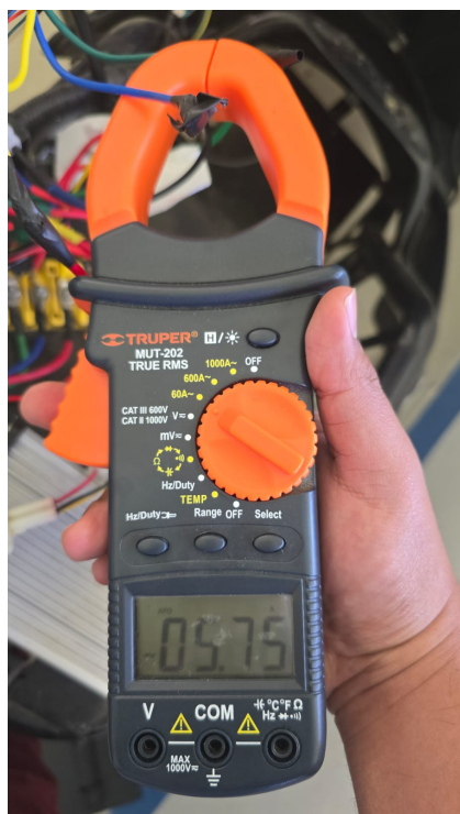
Figura 34: Medición al 100 % de aceleración de la corriente de la fase azul (B)
