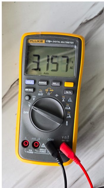
Figura 42: Voltaje CA de la Bobina en la Fase B
