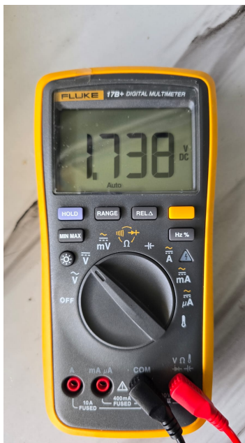
Figura 46: Voltaje Rectificado de la Bobina en la Fase B
