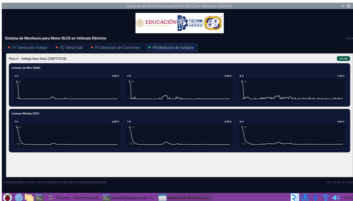
Figura 66: Valores de voltajes entre fases sin acelrecación posterior a la prueba de medición de voltajes
