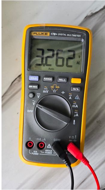
Figura 43: Voltaje CA de la Bobina en la Fase Y
