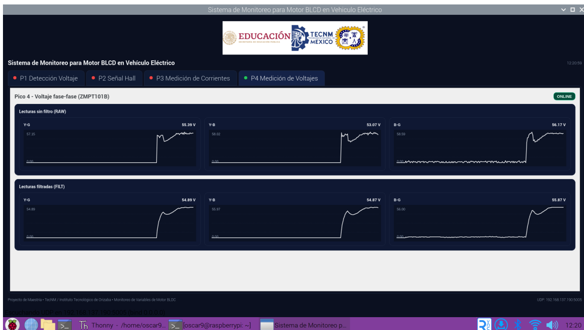
Figura 62: Comportamiento de Aceleración Gradual vista en las Fases del Motor
