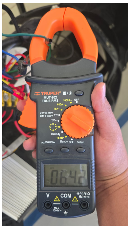
Figura 35: Medición al 100 % de aceleración de la corriente de la fase verde (G)
