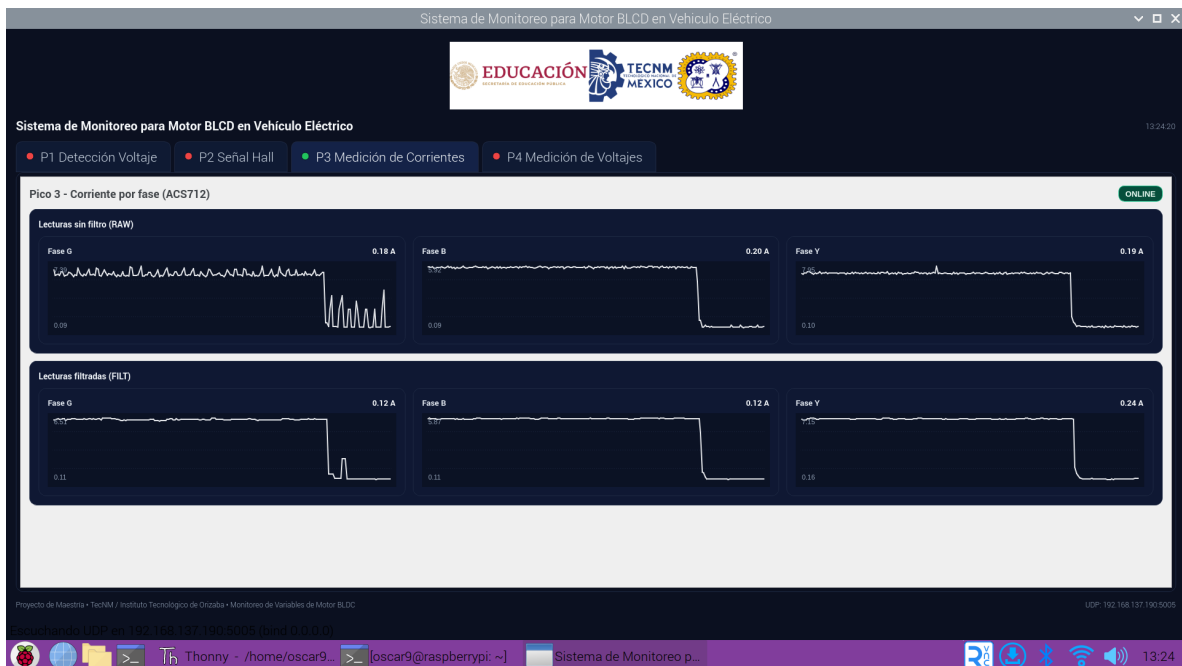
Figura 59: Valores de Corriente de cada fase al sin Aceleración de la Scooter
