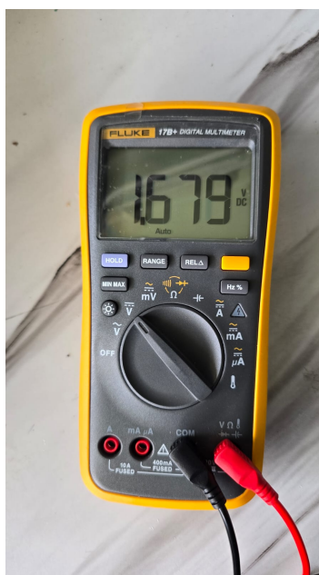
Figura 45: Voltaje Rectificado de la Bobina en la Fase G
