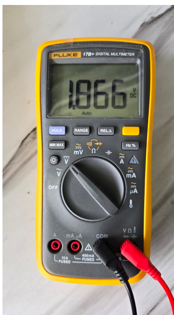
Figura 47: Voltaje Rectificado de la Bobina en la Fase Y
