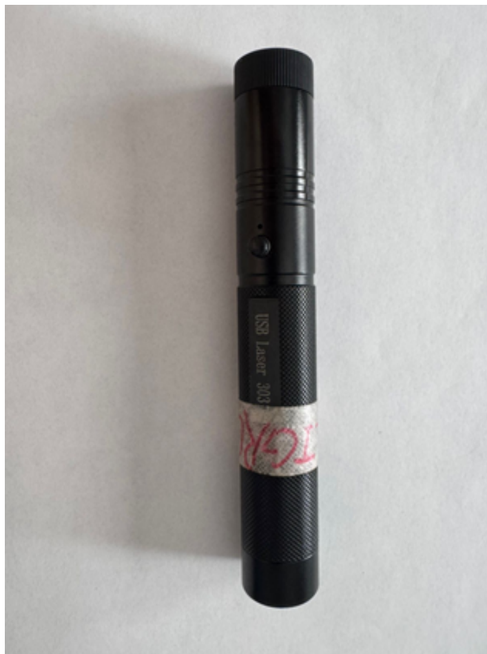
Figura 43: Láser IR 808-1064 nm Clase III .
