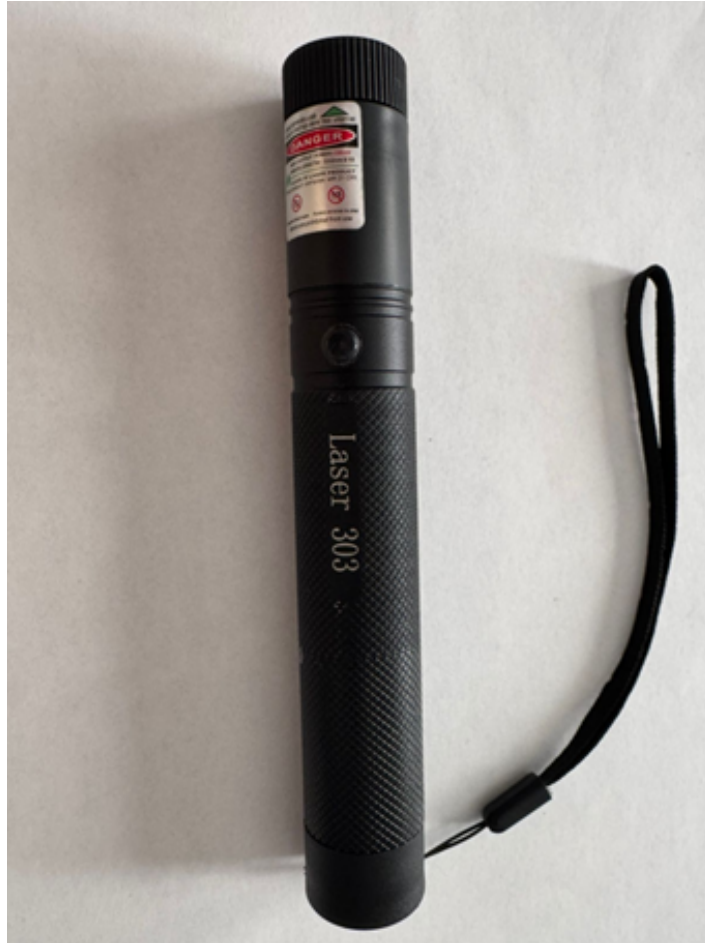
Figura 41: Láser verde 532 nm Clase III.
