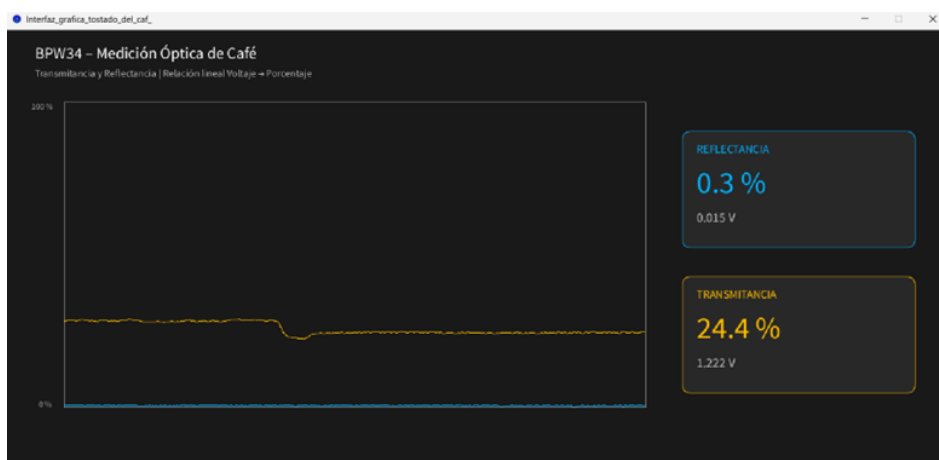
Figura 90: Tostado medio y su medición con el láser rojo.
