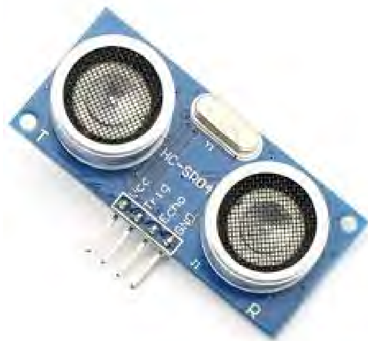
Figura 13: Imagen representativa del sensor ultrasónico HC-SR04 utilizado para la retro-alimentación de posición.
