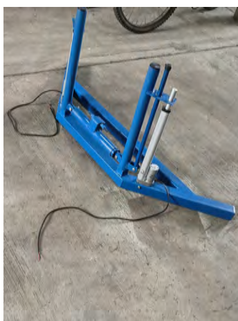
Figura 47: En la colección de imágenes se puso pintura en espray para detener la corrosión del PTR con una base neutra y azul en el caso de los 2 modelos y piezas ensambladas.
