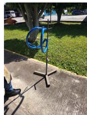
Figura 47: En la colección de imágenes se puso pintura en espray para detener la corrosión del PTR con una base neutra y azul en el caso de los 2 modelos y piezas ensambladas.
