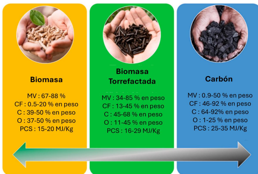
Figura 1.6 Propiedades combustibles de biomasa, biomasa torrefacta y carbón (Lanjekar et al. , 2024).
