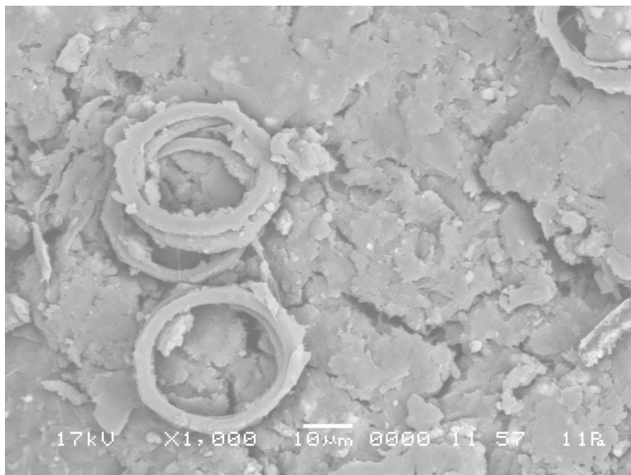
Ilustración 22. Microestructura del biol observada mediante microscopía electrónica de barrido (1000 x).
