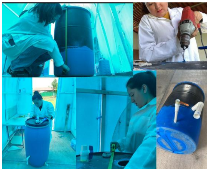
Ilustración 28. Proceso de montaje del biodigestor.
