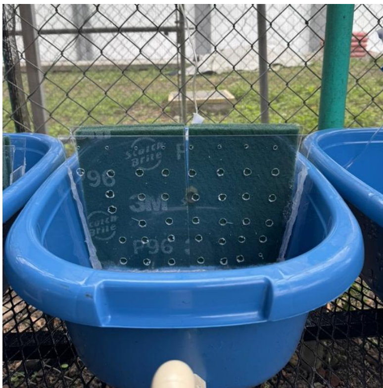
Figura 2.3 Diseño de la celda experimental con soporte para la formación de biopelícula.
