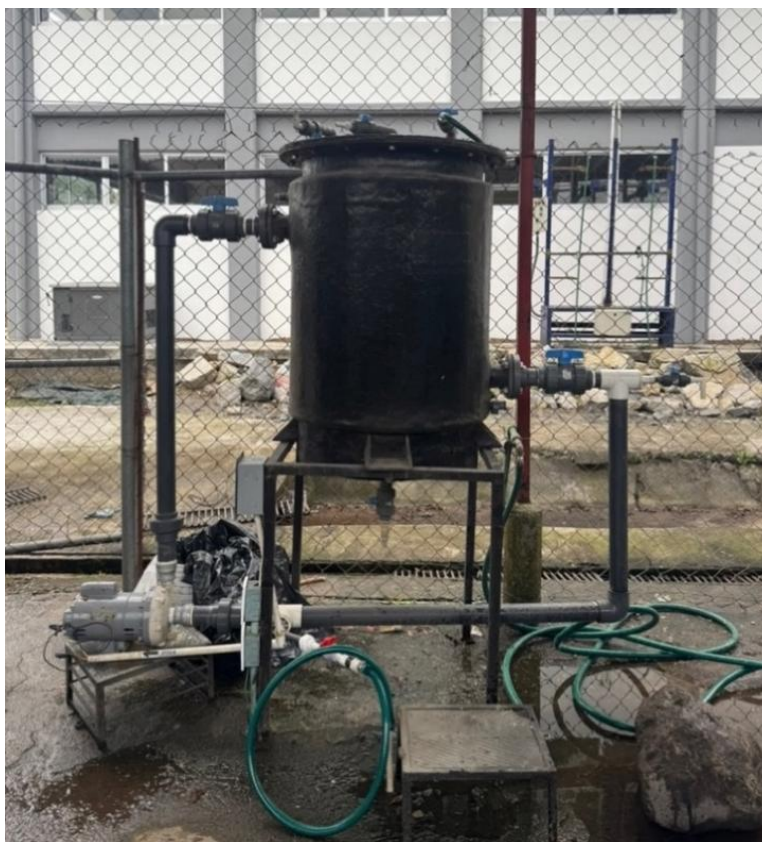
Figura 2.2 Reactor anaerobio de biopelícula fija (FBBR) instalado en la Planta de Aprovechamiento de Residuos del Instituto Tecnológico de Orizaba.
