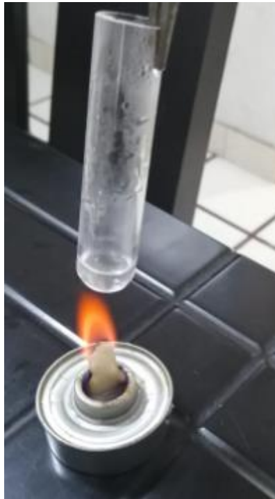
Fig. 19. Medición del calor que entrega el mechero al sistema
