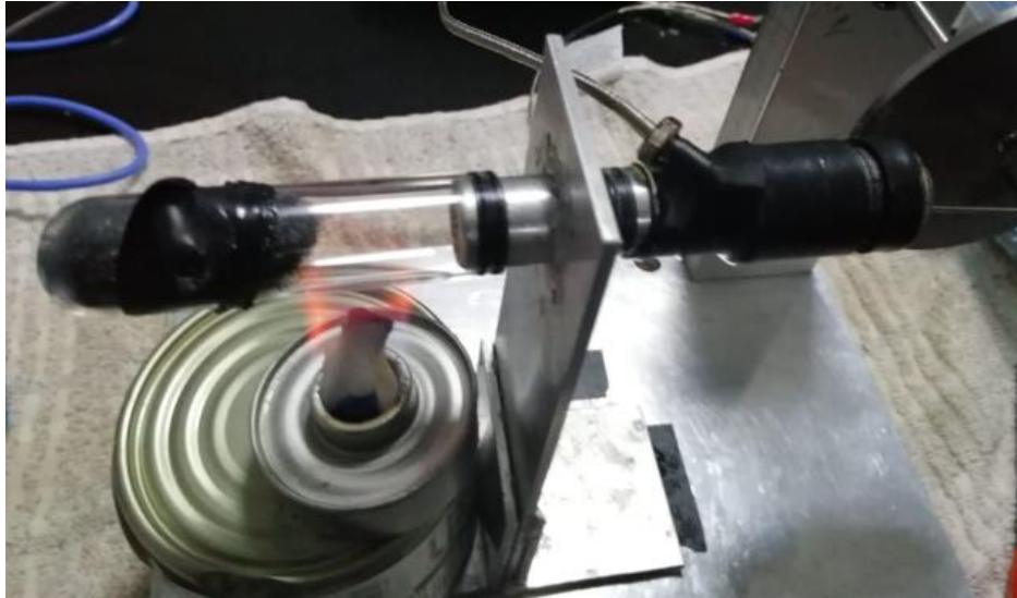
Fig. 14. Termopar acoplado para medición de temperatura.
