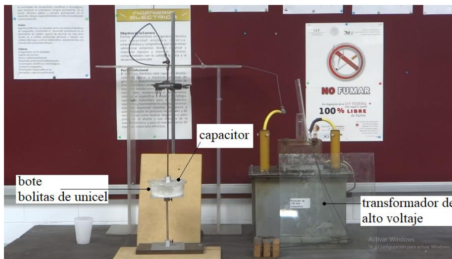
Figura y Componentes del circuito usado. Capacitor excitado con corriente alterna.
