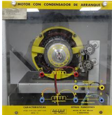
Figura d Motor con condensador de arranque del sistema electromecánico Lab-Volt EMS8251. Características: 175W, 1715rpm, 120V, 4.6A. 60Hz, 1 \phi .
