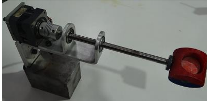
Figura k Motor a pasos (el motor paso a paso tiene acoplado un imán de neodimio en su eje).
