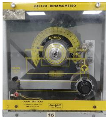
Figura e Electro-dinamómetro del sistema electromecánico Lab-Volt EMS8251. Características: Velocidad: 0-5000rpm, Par: 0 - 27lb _r •plg
