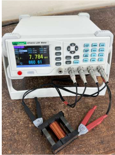
Figura 7.13: Medición de la inductancia del inductor L_1
