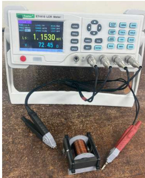
Figura 7.15: Inductor secundario y medición de inductancia realizada en laboratorio.
