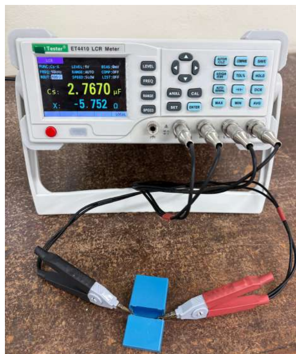
Figura 7.14: Medición del arreglo de capacitores
