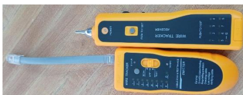
Ilustración 75 Probador e identificador de cable ethernet
