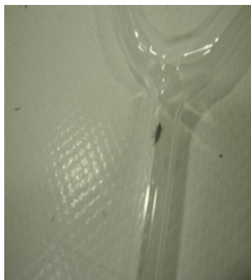
Figura 7. Tuvo en "Y" del olfatómetro para estudiar el comportamiento de larvas de Insectos.
