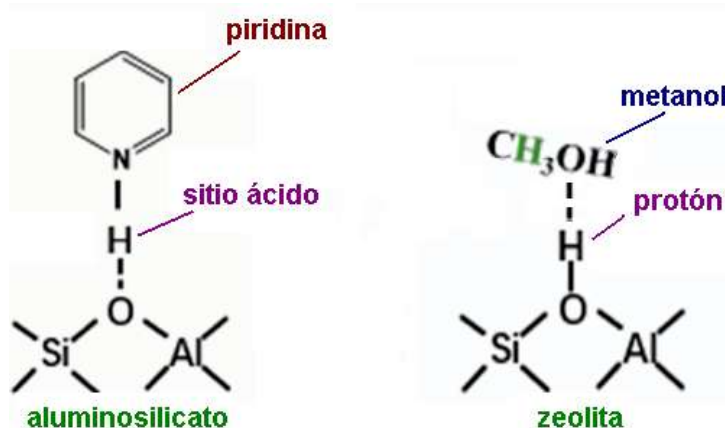
Figura 6.10. Moléculas de la piridina y del metanol adsorbidas en sitios ácidos expuestos en la superficie del aluminosilicato cristalino o zeolita. (Adaptadas de Sun y col., 2024).
