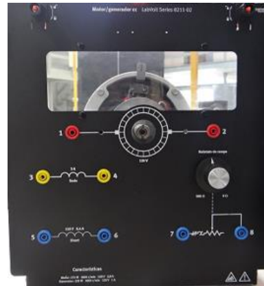
Figura viii Máquina de corriente directa del sistema electromecánico Lab-Volt EMS8211.
