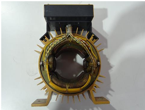
Figura d Estator de la máquina de corriente directa del sistema electromecánico Microlab De Lorenzo.
