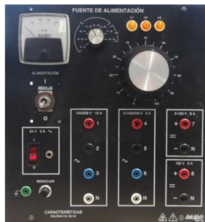
Figura b Módulo de suministro de potencia EMS8821
