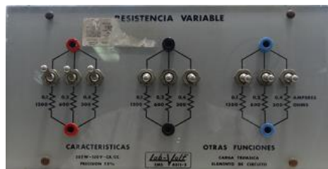
Figura i Carga resistiva EMS8311 252W, 120V, ca/cd, precisión \pm 5\% .
