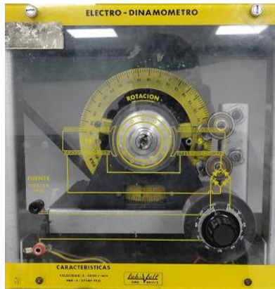
Figura a Electrodinamómetro (freno) del sistema electromecánico Lab-Volt EMS8911.
