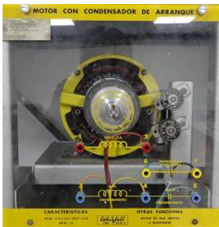
Figura iv Motor con condensador de arranque del sistema electromecánico Lab-Volt EMS8251.
