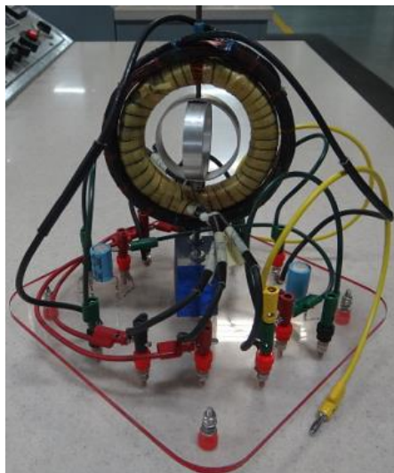
Figura a Prototipo “motor elemental con condensador de marcha”. La bobina 1 envuelve a la bobina 2.
