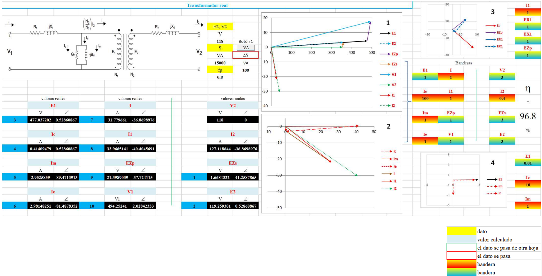
Figura xvi Cálculo de corrientes y voltajes en forma polar y diagramas fasoriales.
