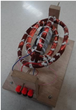
Figura a Motor de inducción trifásico elemental.
