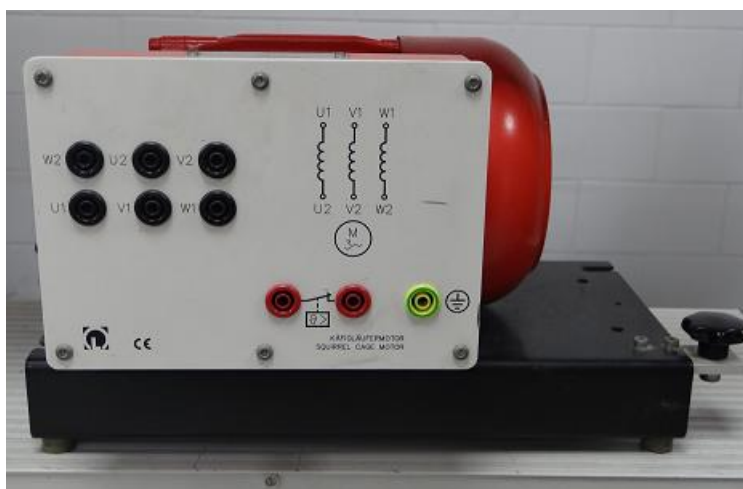
Figura xiv Motor de inducción del sistema electromecánico Leybold Didactic.
