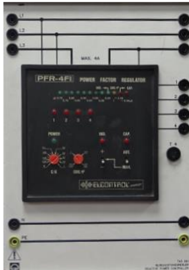
Figura xxii Controlador de potencia reactiva con corrección del factor de potencia del equipo Leybold Didactic.
