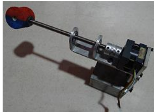
Figura a Prototipo “generador elemental de corriente alterna trifásico”.
