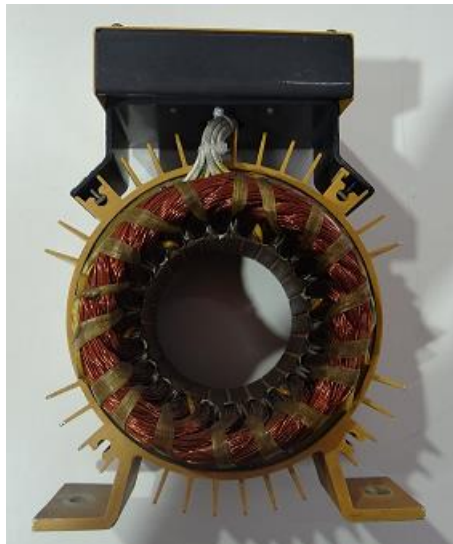
Figura i Estator del motor de inducción del sistema electromecánico Microlab de Lorenzo.
