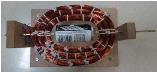
Figura c Disposición de las bobinas del prototipo. El giro de las bobinas está restringido por la longitud de los cables de conexión.
