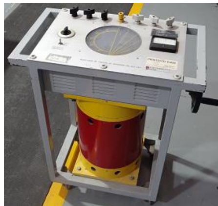
Figura t Regulador de tensión de inducción Mod. ULE 821
