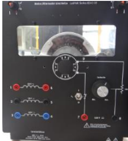
Figura vi Máquina síncrona del sistema electromecánico Lab-Volt EMS8241.
