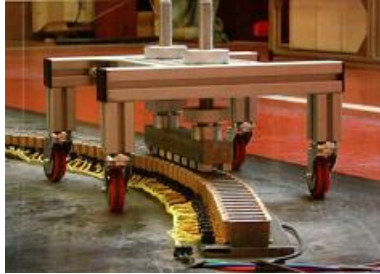
Figura 34 Motor lineal de imán permanente.
