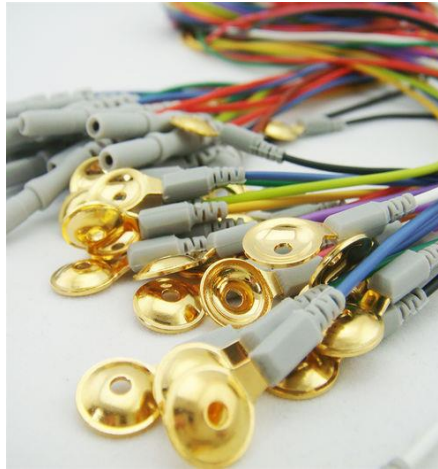
Figura 2.3. Electrodo de Ag/AgCl de copa [1].
