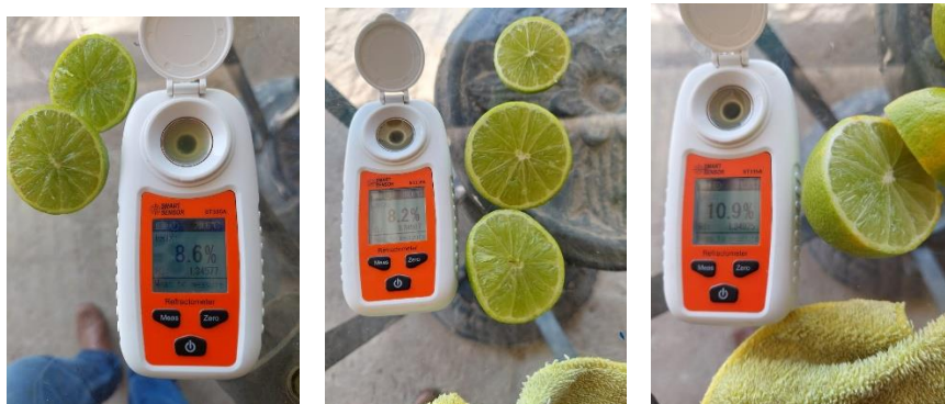
Fig. 21 Toma de muestras para medir °Bx
