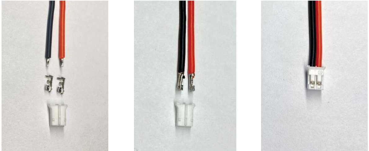
Figura 3-28: Fabricación de puentes con conectores JST
