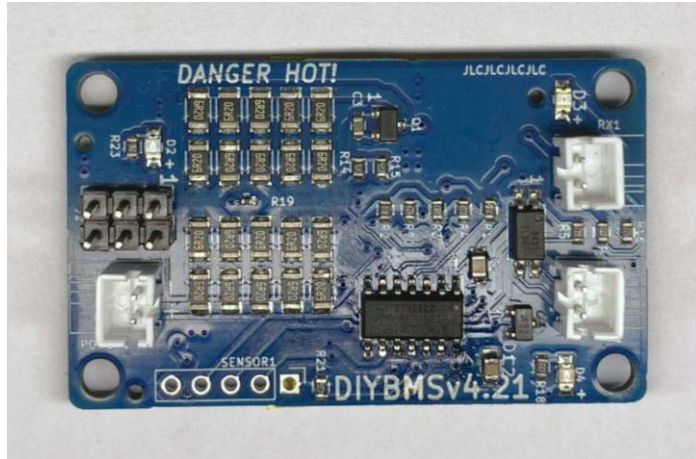
Figura 3-23: Tarjeta balanceadora terminada con todos sus componentes soldados
