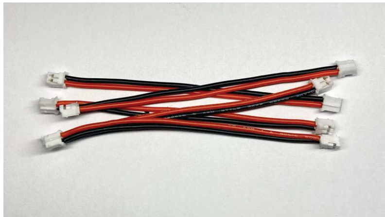
Figura 3-29: Puentes con conectores JST terminados
