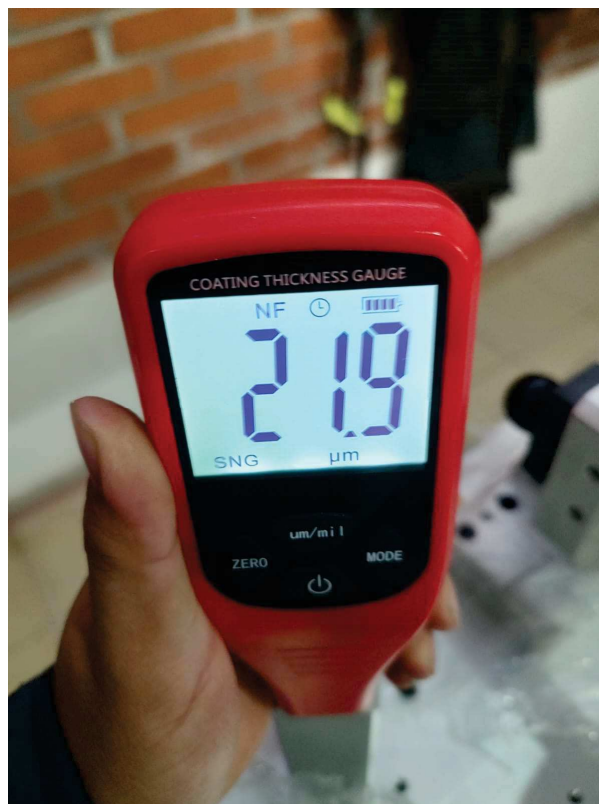
Ilustración 22 Anodizado de 44 minutos
