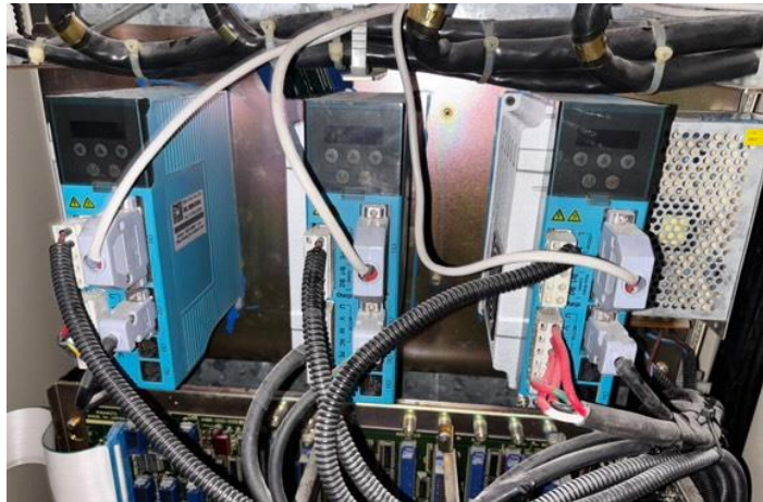
Figura 78. Controladores nuevos del CNC
