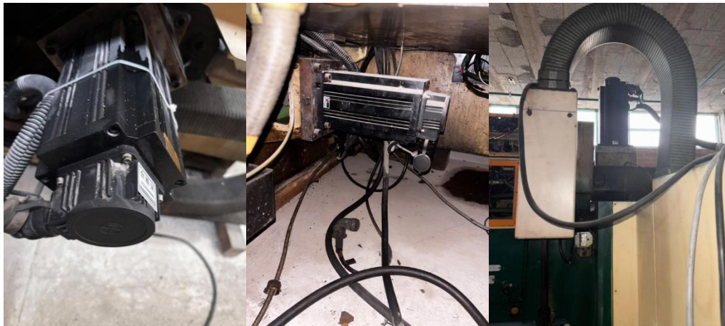
Figura 79. Servos antiguos del CNC
