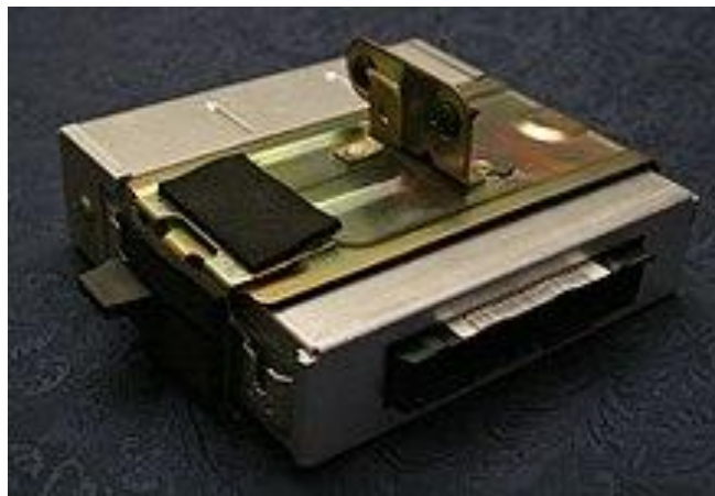
Figura 2.19.- Centralita electrónica con soporte metálico
