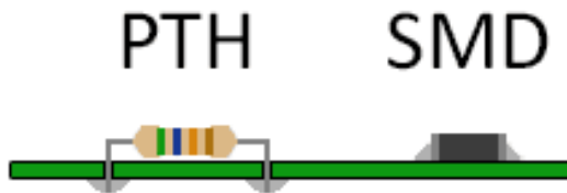
Figura 3.1.2: Tecnologías de componentes electrónicos PTH y SMD.
