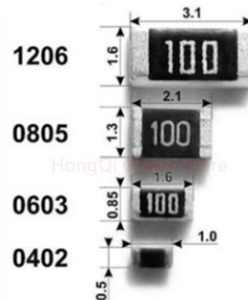
Figura 3.3.6: Empaquetados de resistor SMD.
