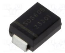
Figura 3.3.35: Empaquetado DO-214 (SMB).
