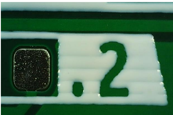
Figura 3.5.12: Inspección de serigrafía.
