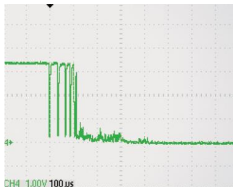
Figura 3.3.21: Oscilograma de efecto rebote en interruptor.
