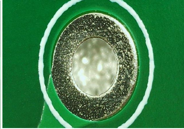
Figura 3.5.15: inspección de terminales PTH.
