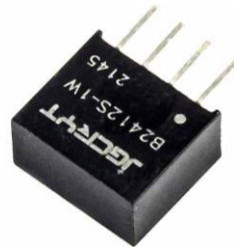
Figura 3.3.43: Regulador DC-DC aislado.
