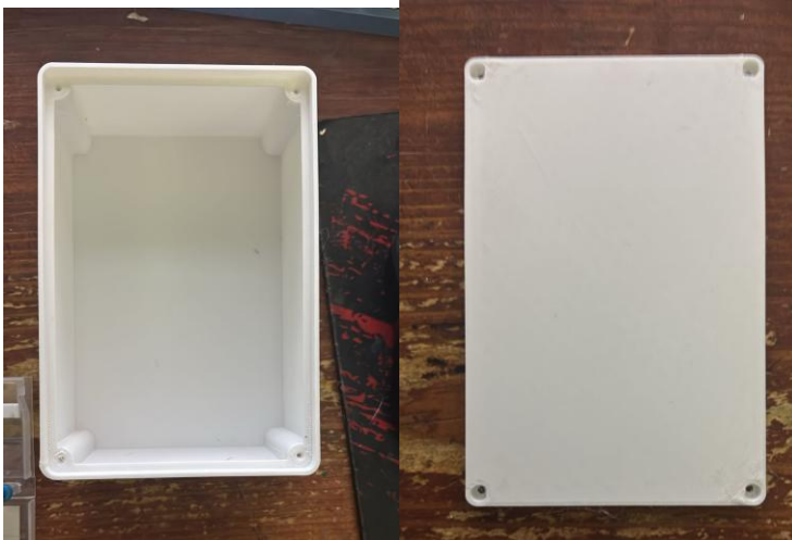
Ilustración 24. Carcasa impresa en 3d
