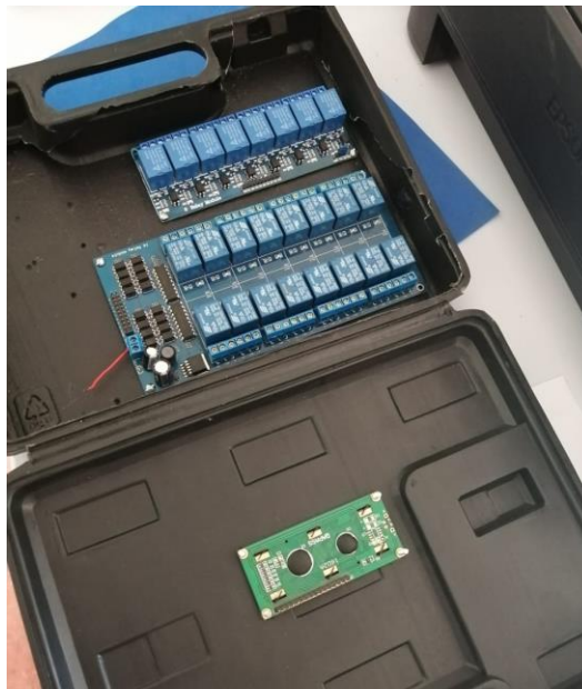
FIG. 30 Ensamble de la pantalla LCD y los módulos de relevadores. Fotografía propia
