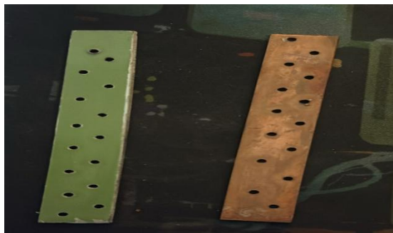
(Imagen 3.1 perforación de barras mediante barrenado)
