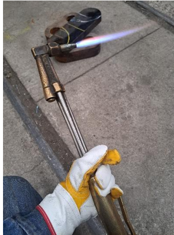
Figura 27: Oxicorte en su estado de corte
