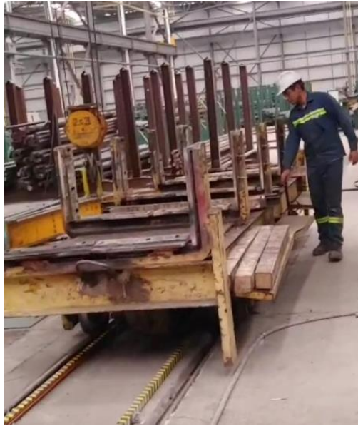
Figura 21: Prueba de funcionamiento del transfer de carga No.1
