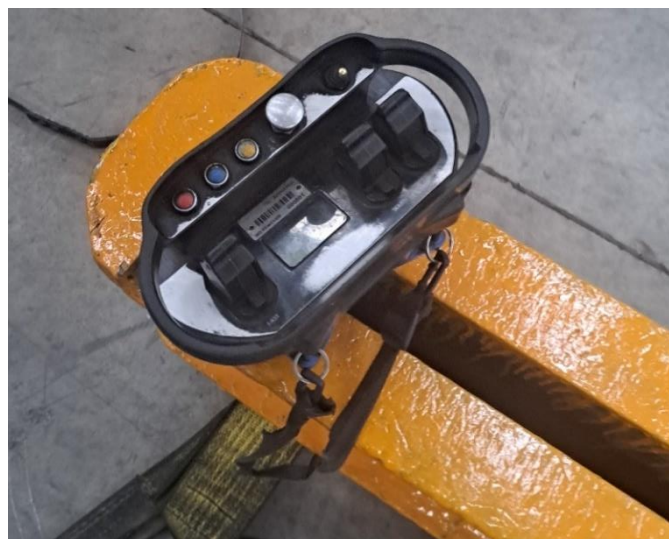
Figura 28: Control remoto de grúa de carga
