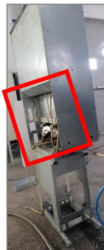
Imagen 14.40 Ubicación De Módulos IGBT.
