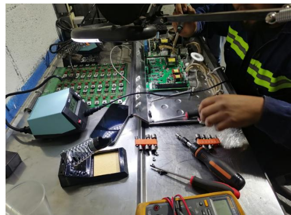
Imagen 13.50 Comienzo De Reparación De Tarjetas Electrónicas..
