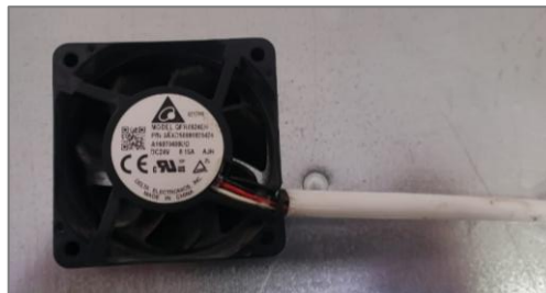
Imagen 14.35 Ventilador De Refrigeración De Tarjetas Electrónicas.
