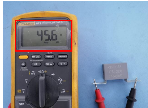
Imagen 14.89 Medición De Capacitancia De Condensador De Absorción.
