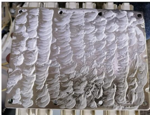
Imagen 14.41 Aplicación De Pasta Térmica En Módulos IGBT.
