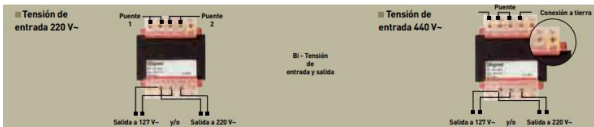
Figura 3.3 Especificaciones del transformador (Ficha técnica pagina 2)
