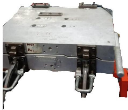
Figura 2.3 Molde para inyeccion de mezcla
