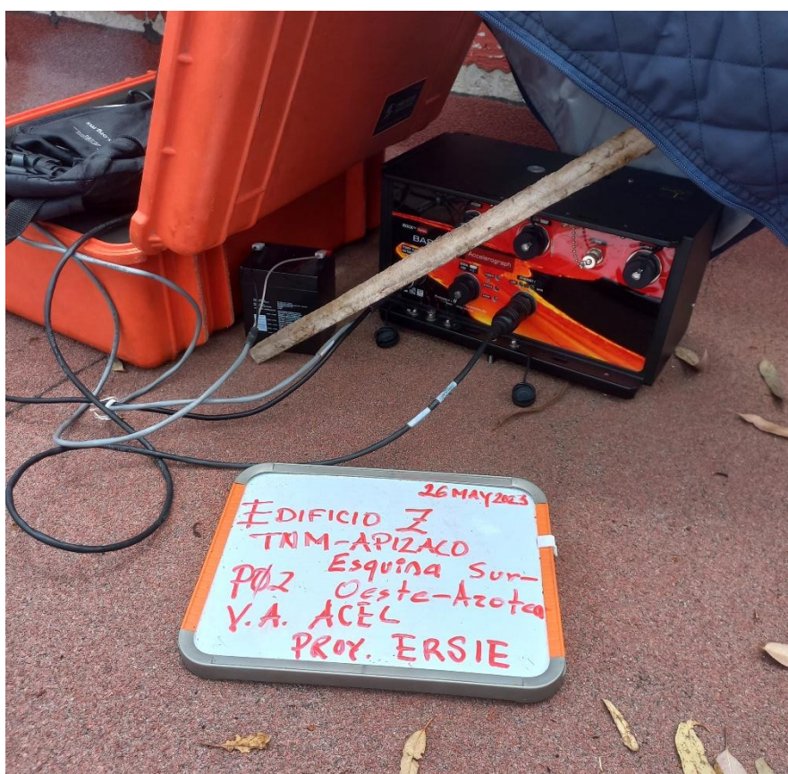
Imagen 11. Vibración Ambiental, Edificio Z, Punto 02, Esquina Suroeste, Azotea
