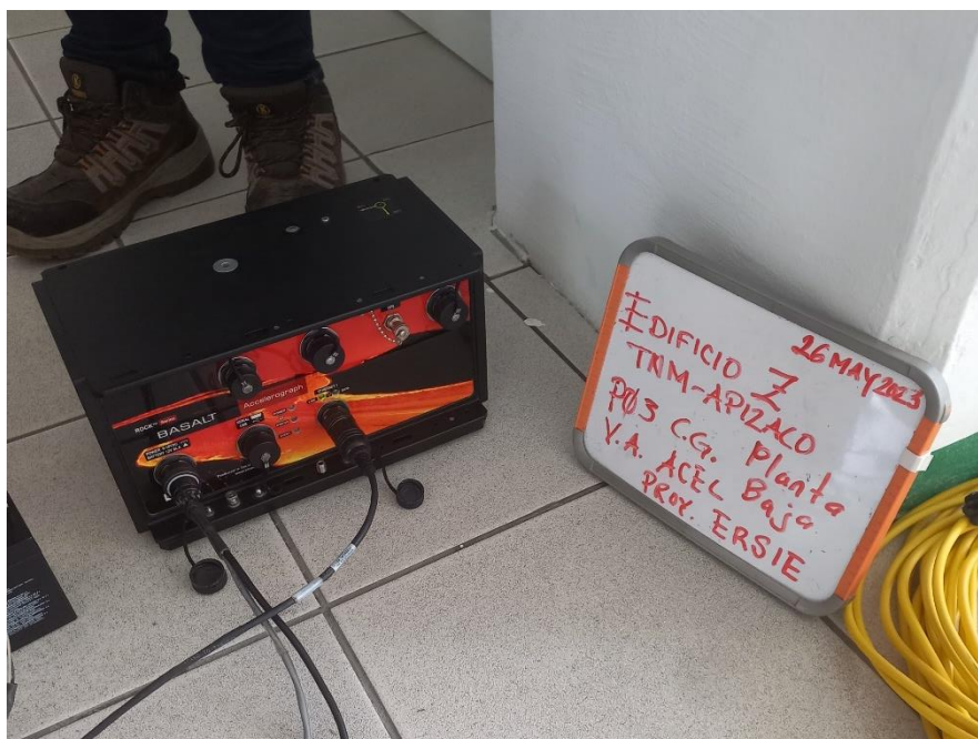
Imagen 12. Vibración Ambiental, Edificio Z, Punto 03, Centro Geométrico, Planta baja
