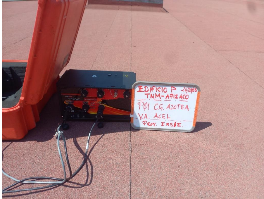
Imagen 7. Vibración Ambiental, Edificio P, Punto 01, Centro Geométrico, Azotea
