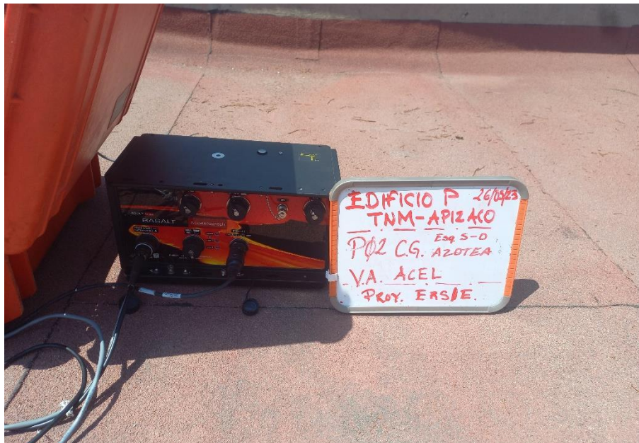
Imagen 8. Vibración Ambiental, Edificio P, Punto 02, Esquina Suroeste, Azotea
