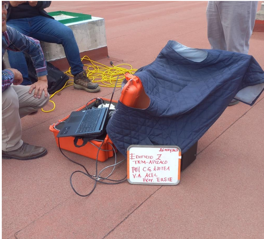
Imagen 10. Vibración Ambiental, Edificio Z, Punto 01, Centro Geométrico, Azotea
