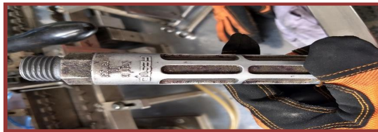
Imagen 1.63 Válvula con residuos del proceso. [Fuente: IEA 2019]
