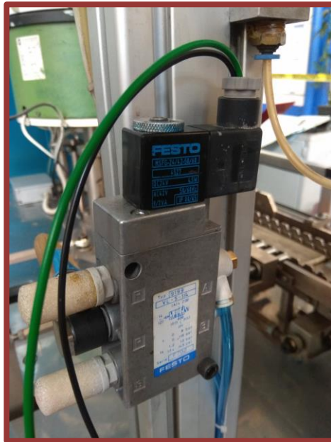
Imagen 1.69 Electroválvula montada para el control del pistón. [Fuente. IEA 2019]
