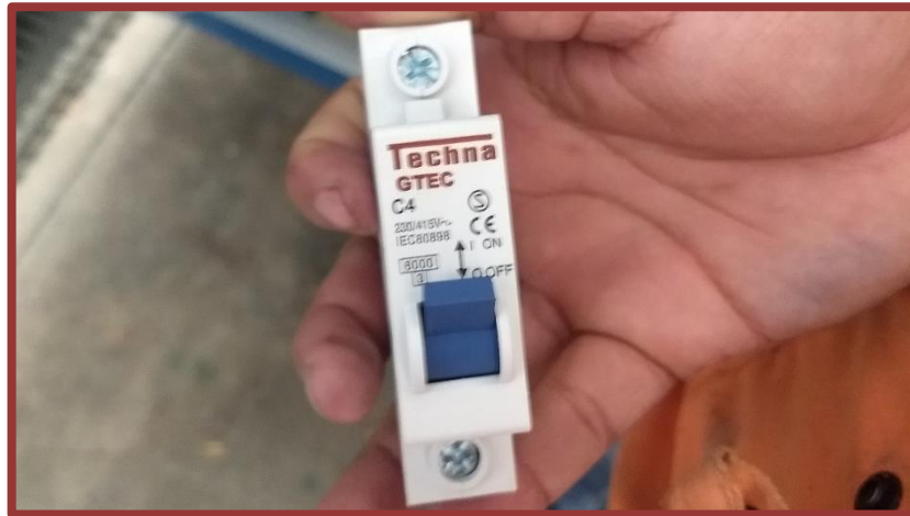
Imagen 1.60 Interruptor Termomagnético para el control de los Ventiladores. (Fuente: IEA 2019)
