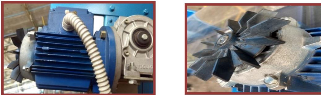
Imagen 1.84 Motores de la banda alimentadora y del inferior de la máquina. [Fuente: IEA 2019]
