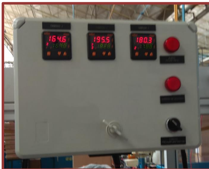
Imagen 1.98 Pirómetros y gabinete instalados e estabilizados como lo requiere el proceso. [Fuente: IEA 2019]
