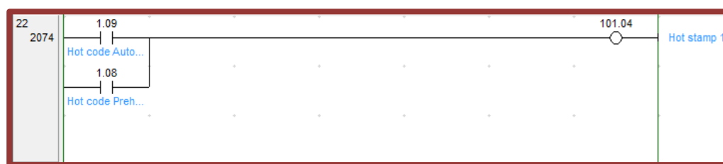
Imagen 1.79 Línea 22 de la modificación del programa del PLC. [Fuente: IEA 2019]
