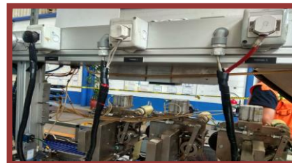
Imagen 1.94 Estructura limpiada y cables con serpentín. [Fuente: IEA 2019]
