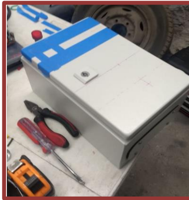
Imagen 1.71. Nuevo gabinete para los controladores de temperatura
