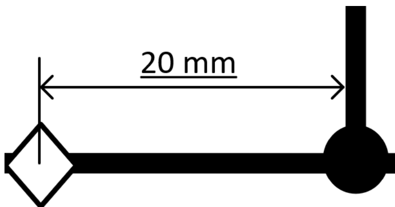
F - 19 Distancia entre clip y ramal de salida
