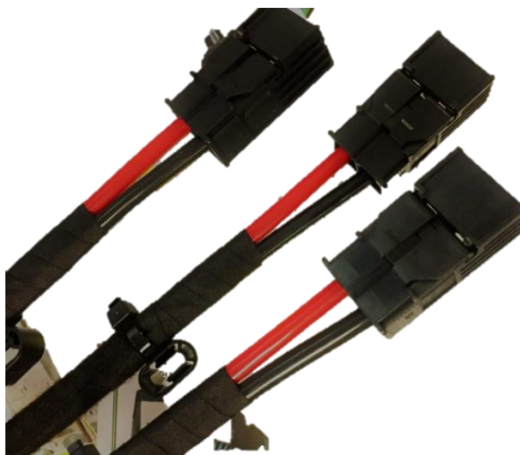
F - 21 Ejemplo de encintado de conectores
