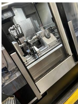
Figura 14 Máquina de rectificado llamada Kellenberger100
