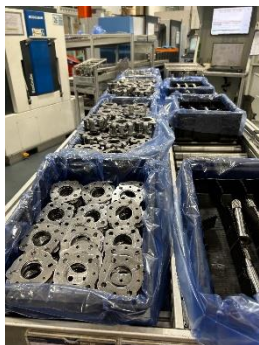
Figura 18 Piezas que conforman una flecha de Ford
