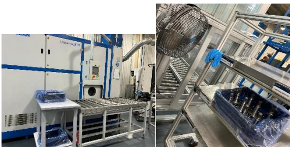
Figura 22 Máquina de lavado térmico
