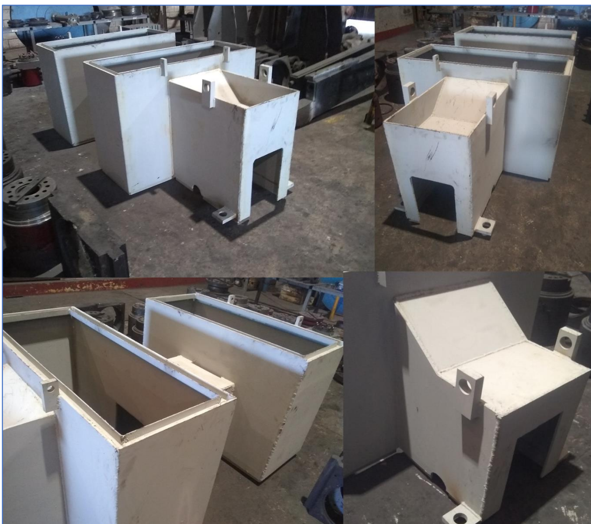
Ilustración 5.1: Fotografías de la cubierta superior desescamador de doble cabezal, fuente propia. [fotografías]
