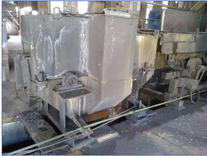
Ilustración 3.4: Desescamador de palanquillas del tren de laminación, fuente propia. [fotografía]
