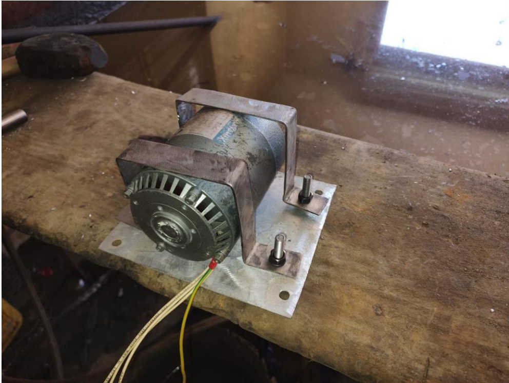
Fig.4.5.14 base construida para el motor trifásico
