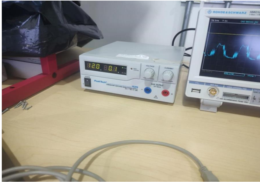
Fig.4.5.23 pruebas sin carga y sin conectar el transformador limitando la verificación completa del sistema
