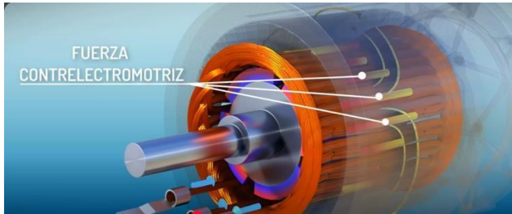
Fig.2.6.4.1 reluctancia de motor tesla modelo3, fuente video de YouTube
