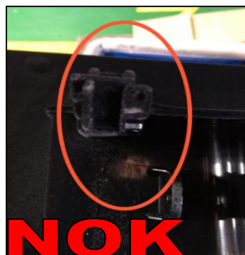
FIGURA 42.1- zona de ensamble de guantero con flock en los orificios
