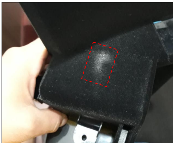
FIGURA 37- Guantero con exceso de adhesivo
