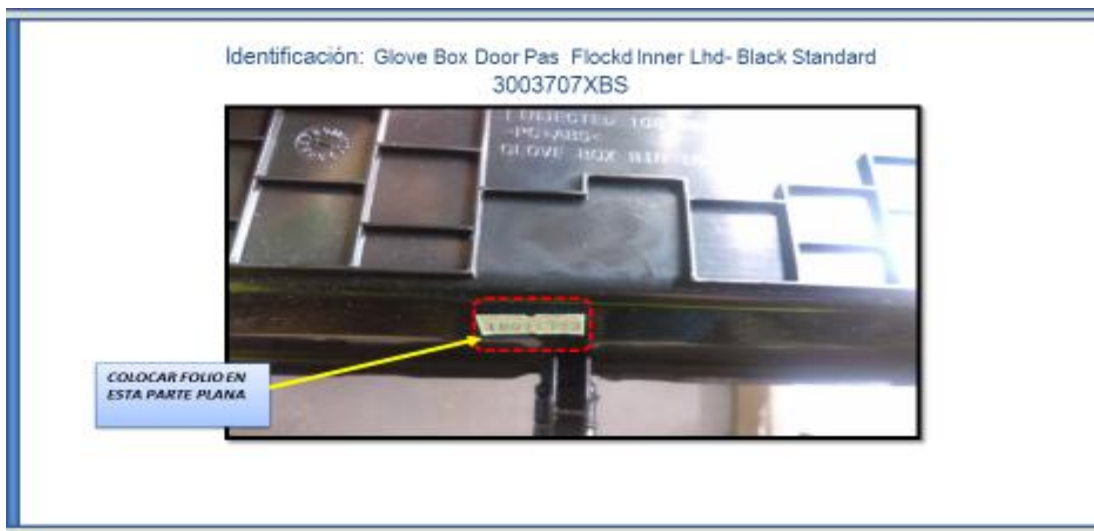
FIGURA 27-ayuda visual de colocación de folio de guantera modelo 30037XBS
