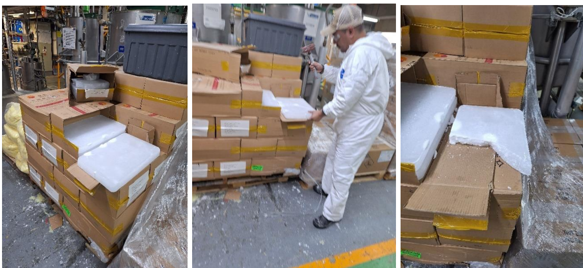
Imagen 2, 3 y 4. La transferencia de parafina ocasiona pérdidas de material.
