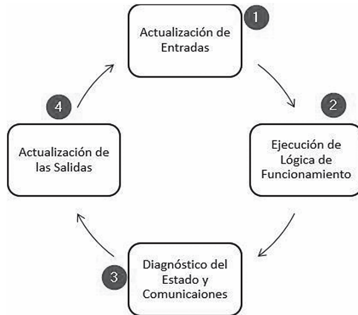
Figura 2. Funcionamiento del PLC.
