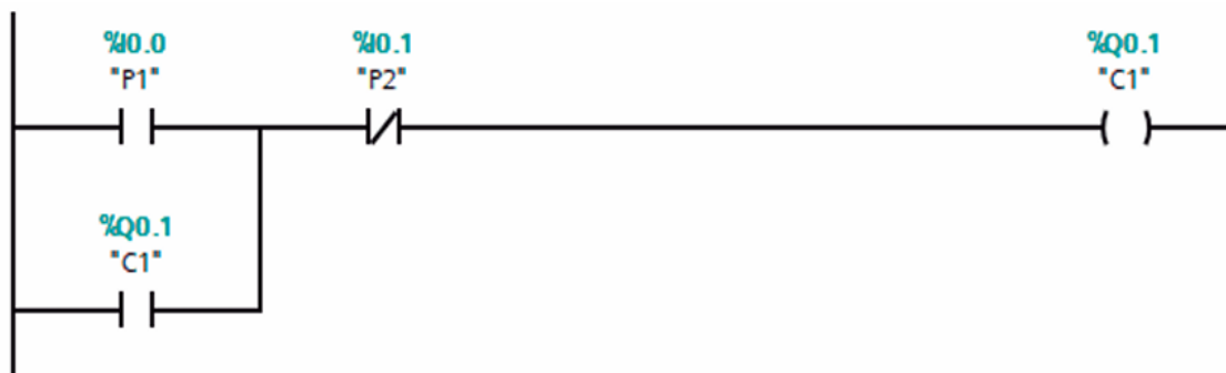
Figura 1.2. Programa para arrancar o parar un motor con lógica programada.
