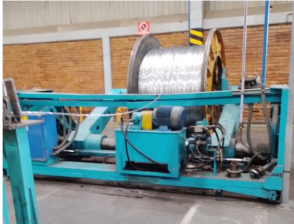
Ilustración 12 Bobina de alimentación central (torón)
