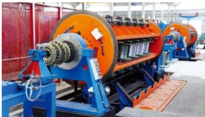
Ilustración 13 Cableadora Rígida (Cuna)
