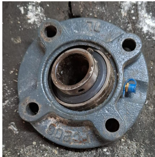
Ilustración 38: Mantenimiento a piza dañada (Chumacera)
