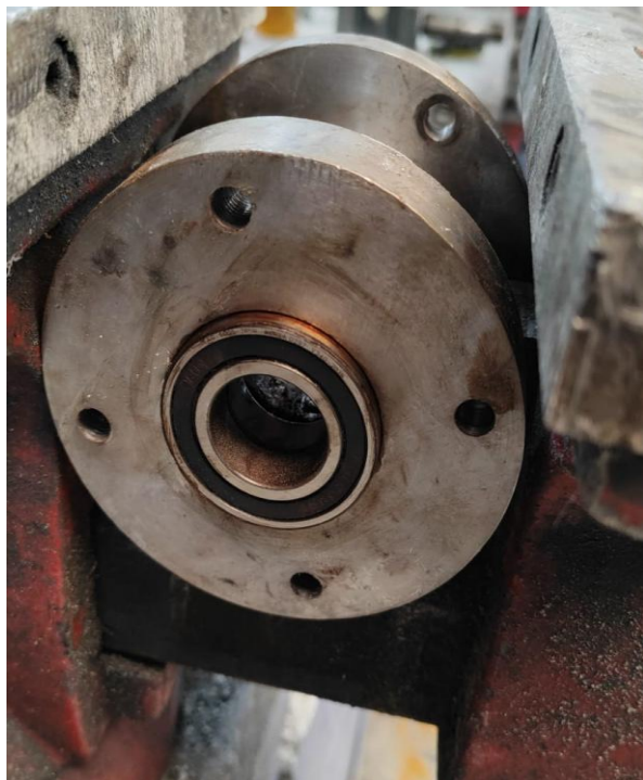
Ilustración 41: Cambio de balero y retenes
