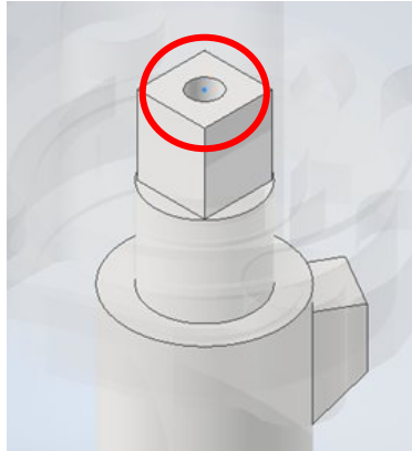
Ilustración 114 Barreno alojamiento para tornillo y arandela fijadores
