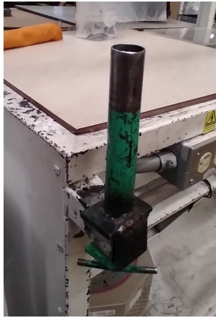
Ilustración 126 Utillaje soporte de ventilador empleado actualmente
