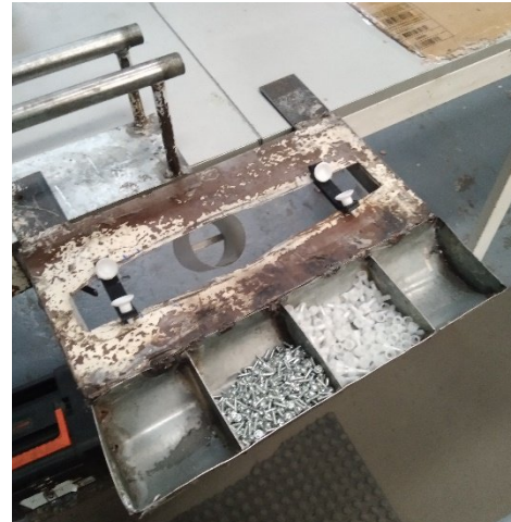
Ilustración 175 Soporte para armado de botonera prototipo
