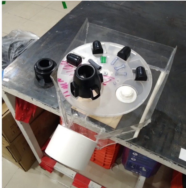
Ilustración 171 Poka yoke embolsado de componentes con componentes colocados (prototipo) centro cruceta en vez de embellecedor
