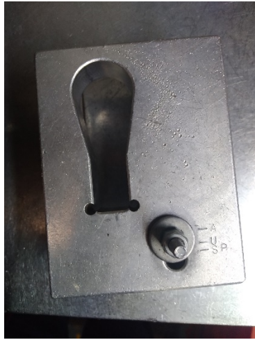
Ilustración 155 Tornillo ensamblado en utillaje
