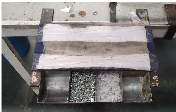
Ilustración 73 Utillaje para ensamble de botonera a cuerpo botonera empleado actualmente
