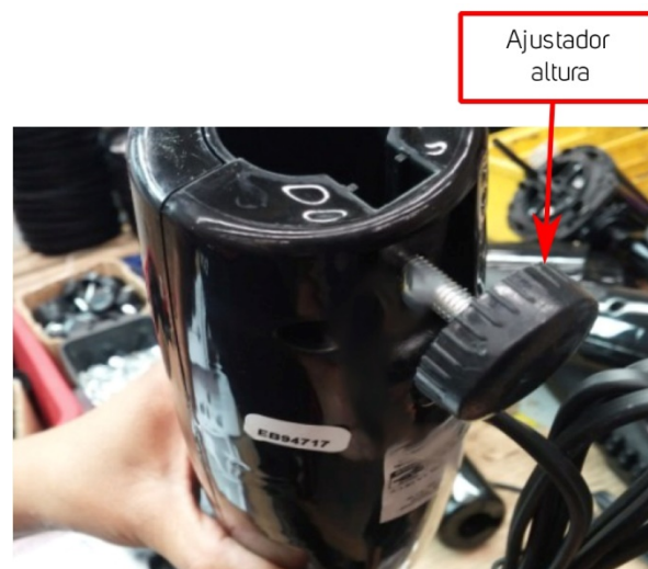
Ilustración 32 Tornillo ajustador en base de ventilador
