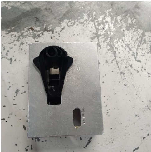
Ilustración 157 Cuello de ventilador montado en utillaje
