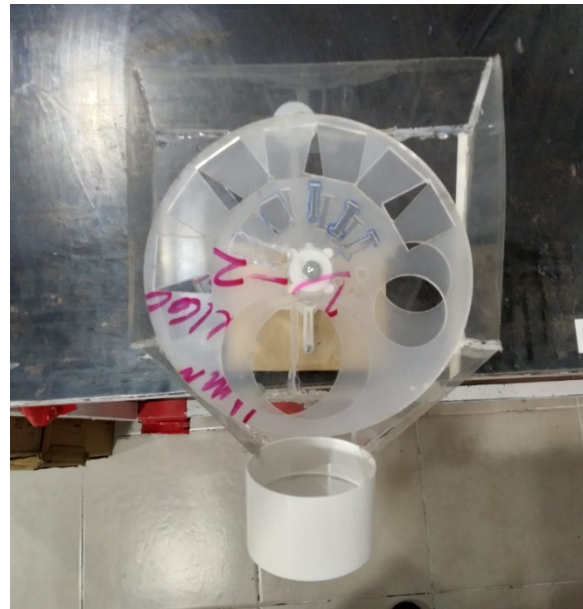
Ilustración 167 FX06 Poka yoke embolsado de componentes (prototipo) vista superior
