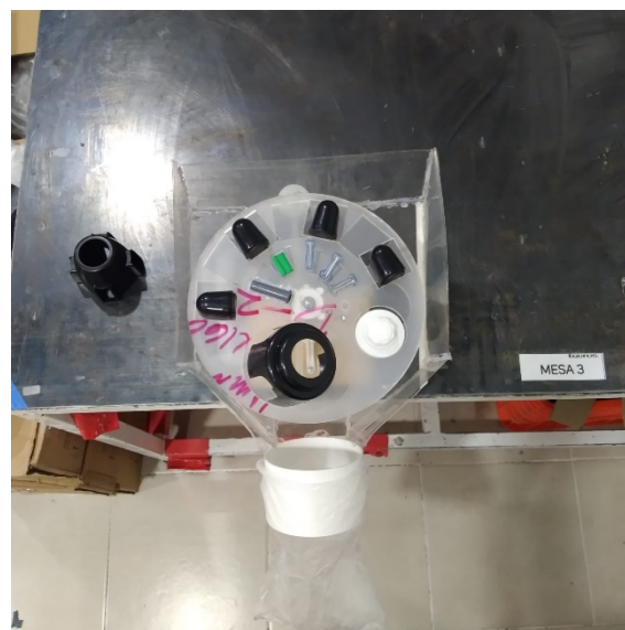
Ilustración 170 Poka yoke embolsado de componentes con componentes colocados (prototipo) vista superior
