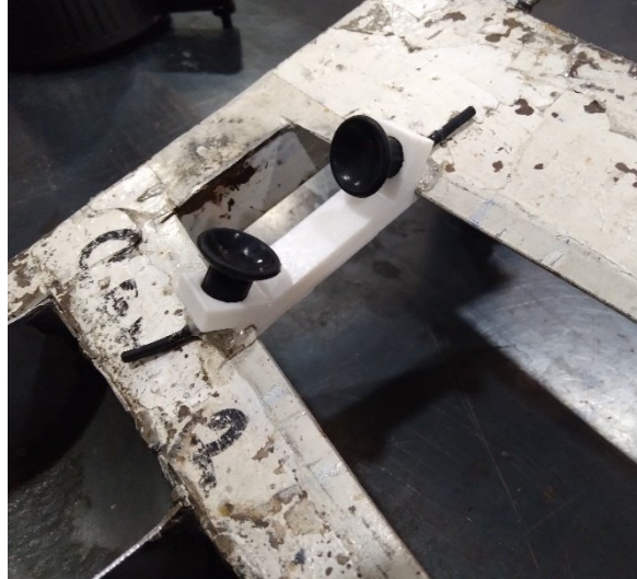
Ilustración 165 Soporte para cuerpo botonera frontal montado en utillaje actual
