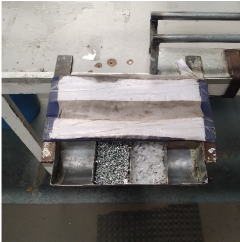
Ilustración 174 Soporte para armado de botonera actual
